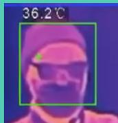
カメラにAI機能を搭載しているため、顔検出が可能。額の温度をピンポイントで測定することができます。
