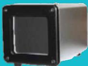
黒体が標準温度サンプル体となり、映像上に常時表示されます。温度補正を行いながら測定温度を保ちます。
